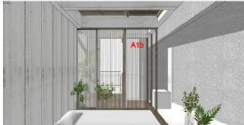
Vách A1b : 2 x 2.3m (b x h) Ray trượt giấu sau khung gỗ cố sẵn. Lើn 1 tấm. Chân rèm may cao 8cm. SL: 3 bộ
