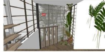
Vách C2 : 3.5 x 3.7m (b x h). Ray trượt âm trần. Treo vào đá bê tông phía trên. Chia 2 tấm 2 bên. Chân rèm may cao 8cm. SL: 1 bộ
