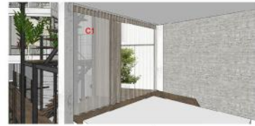
Vách C1 : 2.9 x 2.7m (h x h) Ray trượt âm trần. Treo vào đá bê tông phía trên. Chia 2 tấm 2 bên. Chân rèm may cao 8cm. SL: 3 bộ
