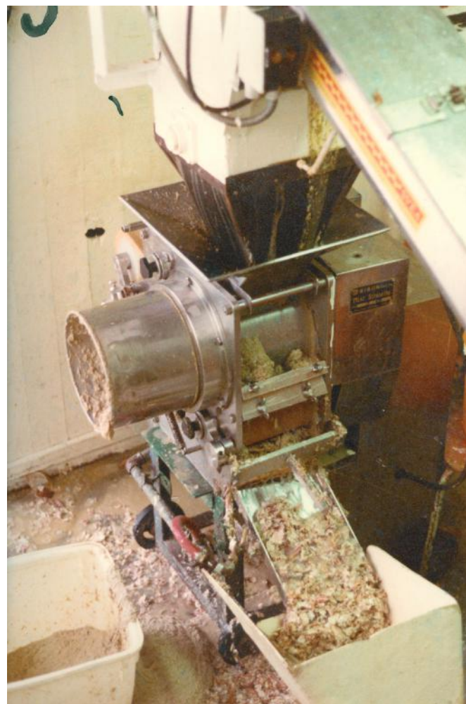
«Bibun»-maskina som kom på 1970-tallet, erstatta noen av renskeoperasjoene. Den meste krabbekjøttet til en masse. Rensking av klør måtte fremdeles gjøres for hånd. Foto: Tove Boneng.
