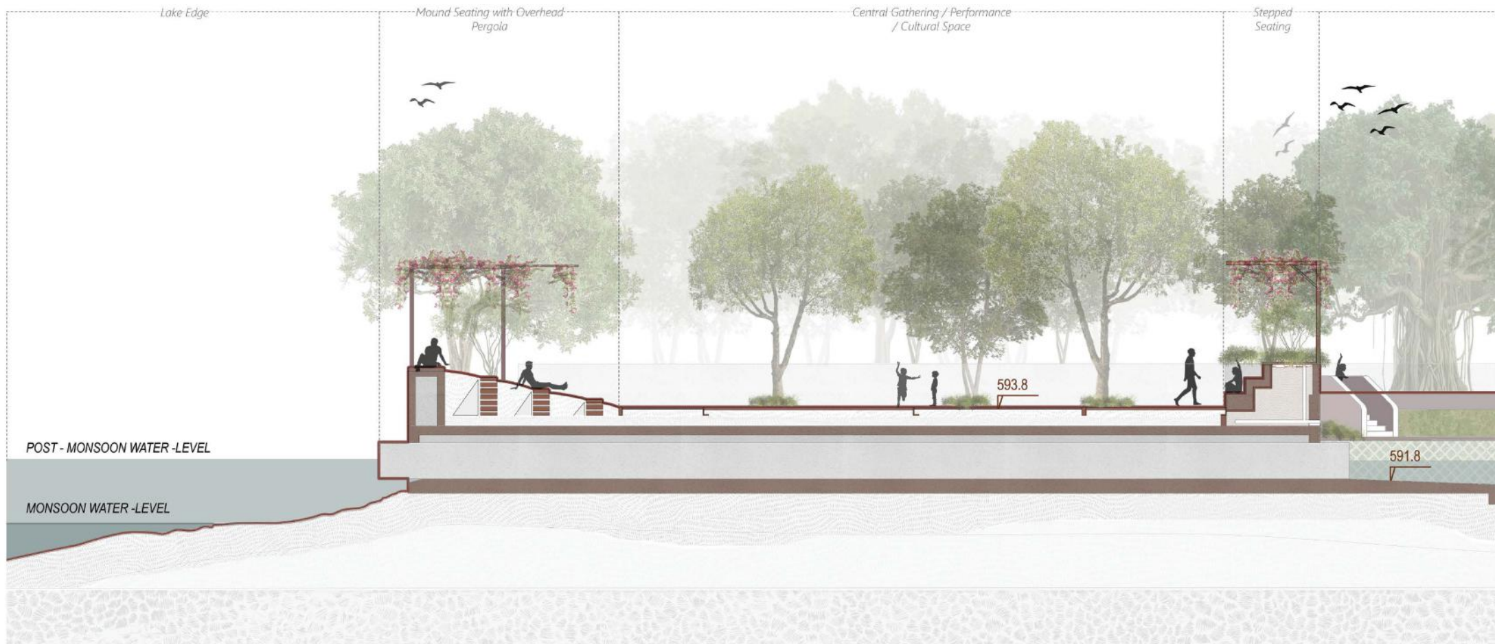
SECTION A-A OVERFLOW CANAL EDGE
