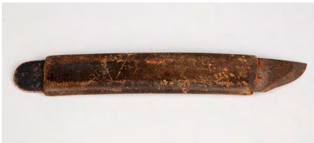
Rett skomakerkniv hadde flere funksjoner. Den ble brukt til utfelling av lær, til å skjære lær etter fast mønster, til beskjæring av snitt og hæl og tilskjæring av bunnlæret.
