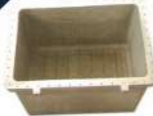
EJB13 BOX 1015 x 800 x 352 111kg, AlSi7Mg T6 Sand Casting
