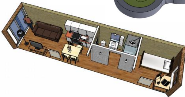
Aménagement d'un conteneur en logement étudiant
