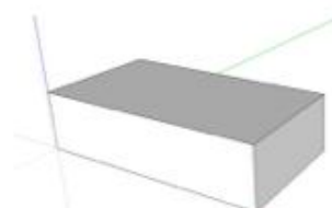
3 – Mettre en volume cette esquisse en indiquant la hauteur Cette fonction est l'extrusion
