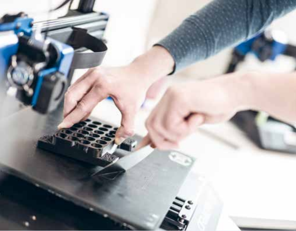
Viele Bauteile der Belichter entstehen zunächst im 3D-Druck. In die fingergroßen Löcher kommen später die Reagenzgläser.
