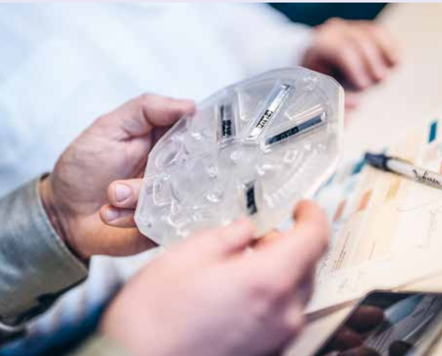
Die Reagenzien sind auf den LabDisks bereits vorgelagert, mit Zentrifugalkraft öffnen sie an definiert geschwächten Nähten.
