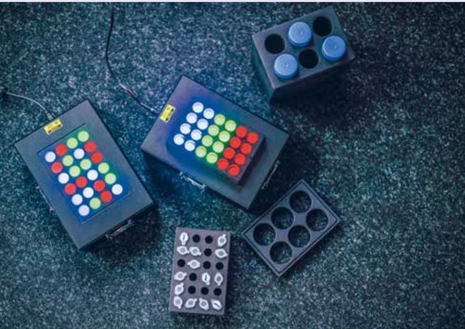
„Die LED haben einen Delay, den muss man eben charakterisieren und einberechnen.“ Die zweite Geräte-Generation kann mehrere Reagenzien gleichzeitig belichten, oft nur für die Dauer von Millisekunden.
