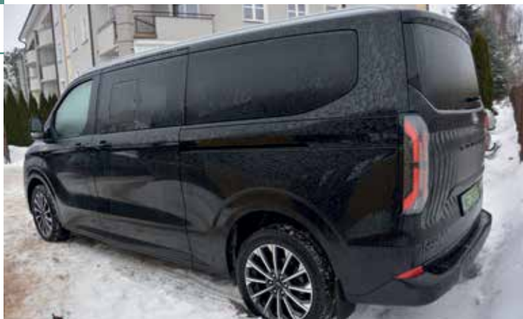
E-Tourneo Custom występuje w dwóch ponad pięciometrowych karoseriach. L1 liczy dokładnie 5.050 mm, L2 o 400 mm więcej, czyli 5.450 mm.
