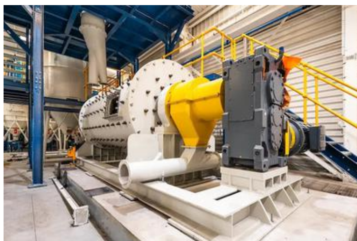
Broyeur à boulets sur la zone pilote du laboratoire d'Ecocem à Chilly-Mazarin (Essonne) - ©Ecocem
