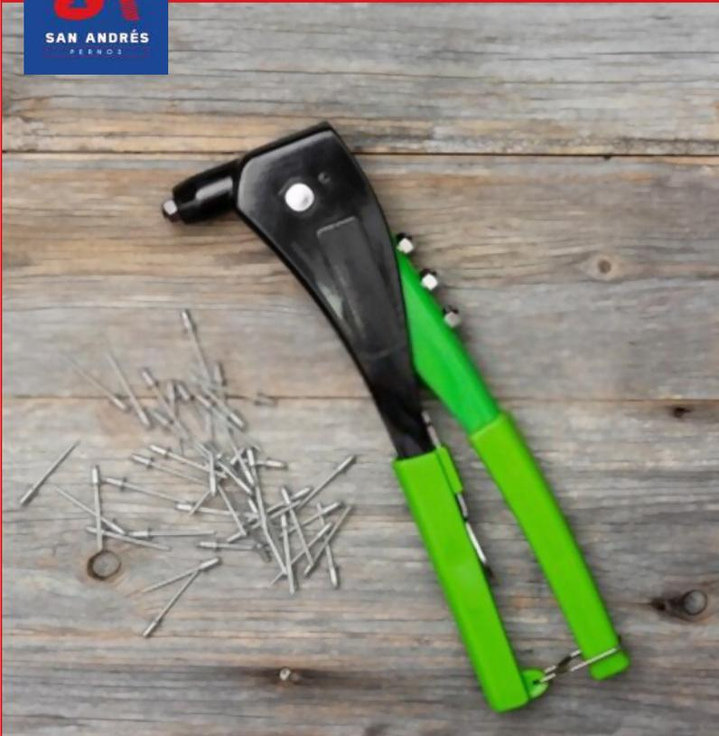
Las herramientas para fijar remaches reciben el nombre de remachadoras. Se utilizan para unir materiales duros, como chapas metálicas y objetos de metal, cuando solo se tiene acceso a una cara del material. Por ejemplo, cuando se fija el guardabarros en el coche o canalones en casa. El remache que elija dependerá del entorno en el que se vaya a utilizar, además del material con el que se trabaje. Por eso, primero tiene que saber el tipo y el tamaño del remache que necesita.
