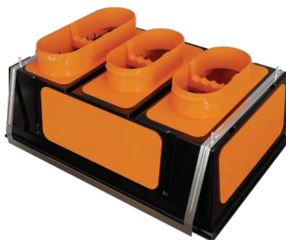
PM600X400 Plénum modulaire de 600x400mm + 2 piquages Ø 200 mm + 1 piquage Ø 250 mm + 3 obturbateurs
