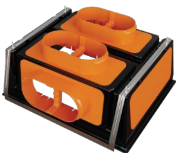
PM500X400 Plénum modulaire de 500x400mm + 3 piquages Ø 200 mm + 2 obturbateurs
