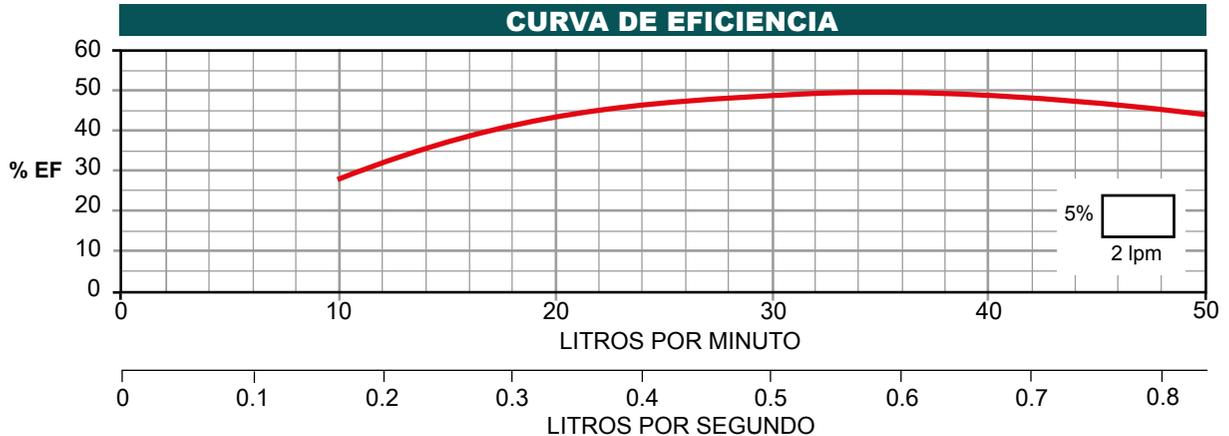
» Trabajar fuera del rango de operación ocasiona alto consumo de energía y daño mecánico en la motobomba.
