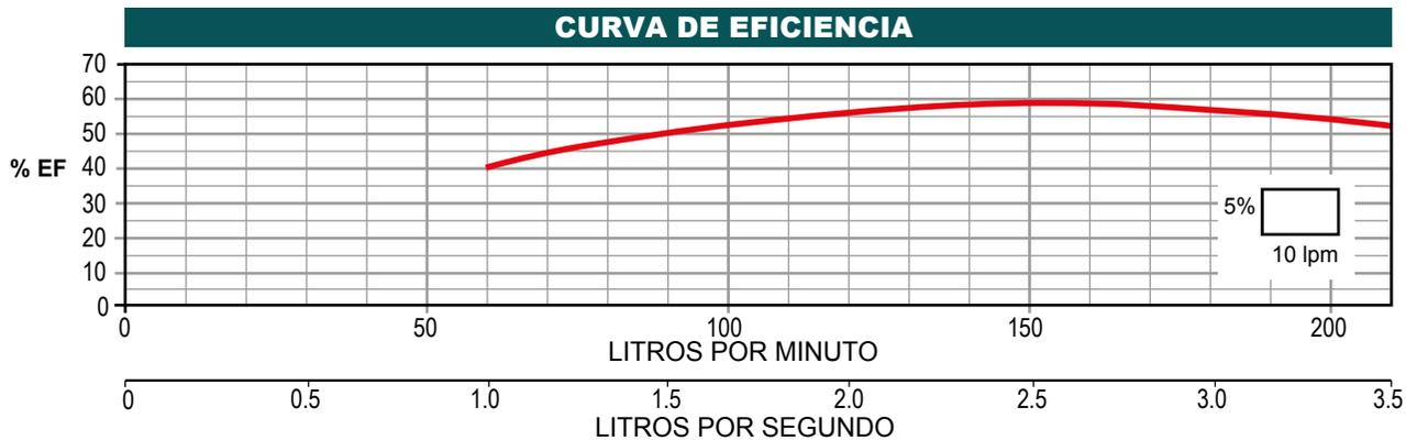
» Trabajar fuera del rango de operación ocasiona alto consumo de energía y daño mecánico en la motobomba.
