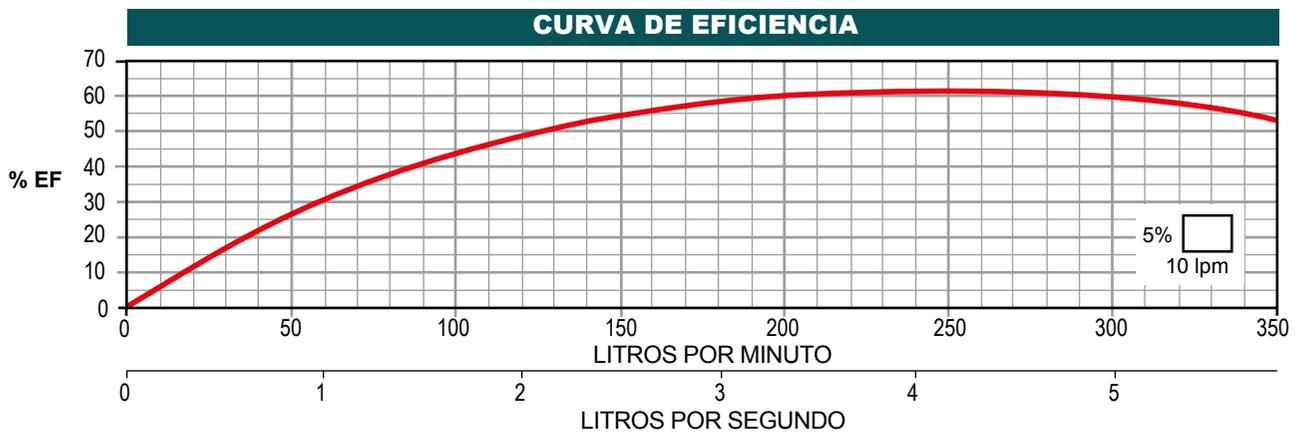
» Trabajar fuera del rango de operación ocasiona alto consumo de energía y daño mecánico en la motobomba.
