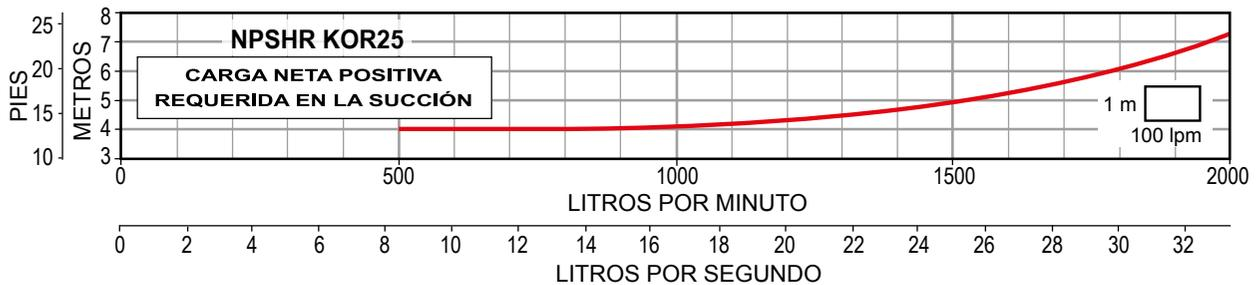
» Trabajar fuera del rango de operación ocasiona alto consumo de energía y daño mecánico en la motobomba.
