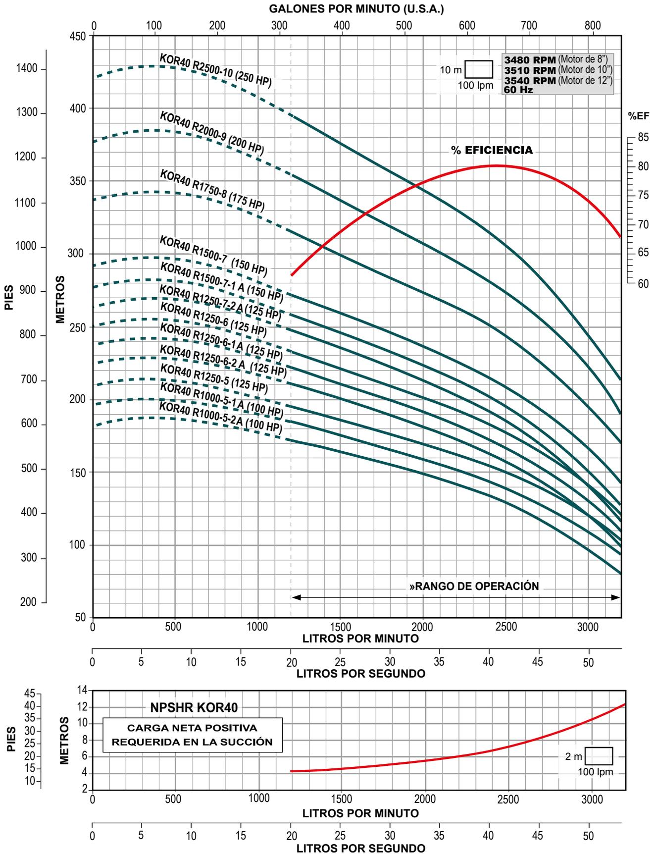
» Trabajar fuera del rango de operación ocasiona alto consumo de energía y daño mecánico en la motobomba.
