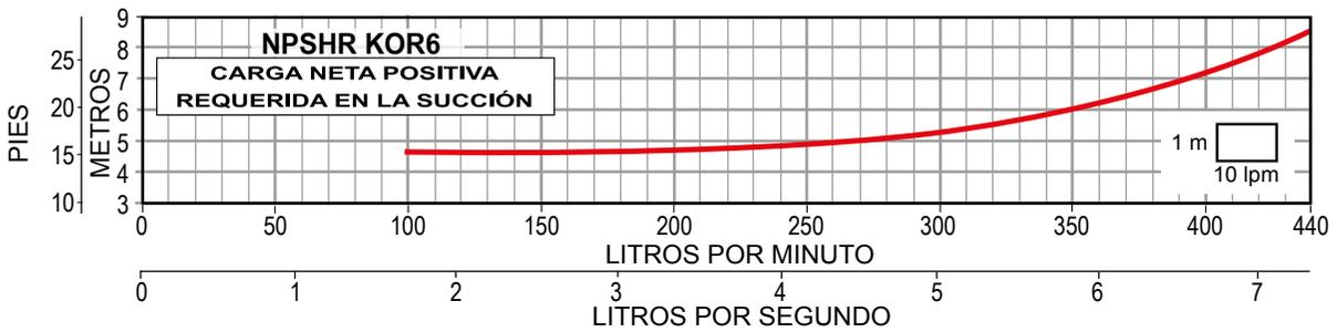
» Trabajar fuera del rango de operación ocasiona alto consumo de energía y daño mecánico en la motobomba.
