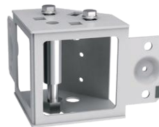
Sockellecke mit Nivellierschraube für Schrank SZB IT oder DSR IT Für die Befestigung der Nivellierschraube in der Sockellecke und für die Verschraubung der Sockellecke mit dem Schrank werden zwei M8-Schrauben mit Unterlegscheiben verwendet, die zusammen mit der Sockellecke geliefert werden.
