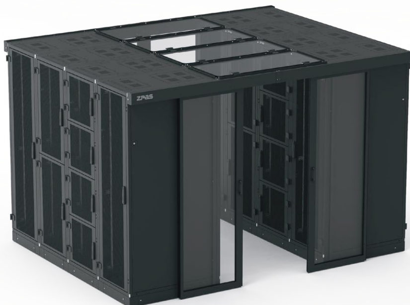
Beispiel einer Kaltgang-/Warmgangeinhausung Data Box bestehend aus 12 Schränken SZB IT 47U, 800 x 1200 mm, Schiebetüren und einem erhöhten Dach. Die Schränke haben keine FüÙe. Auf dem Dach wurden Kabelrinnen montiert.
