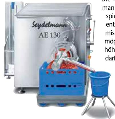
Die Maschinenfabrik Seydelmann präsentiert beim Heimspiel in Stuttgart den neu entwickelten Automatenmischwolf AE 130 M. Er ermöglicht bei niedriger Bauhöhe und geringem Platzbedarf Mischen und Homogenisieren sowie anschließendes Wolfen über den Wolfauslass. Mit entnehmbarem Mischwerk und einer großen Zubringerschnecke ist er als reiner Automatenwolf einsetzbar und
