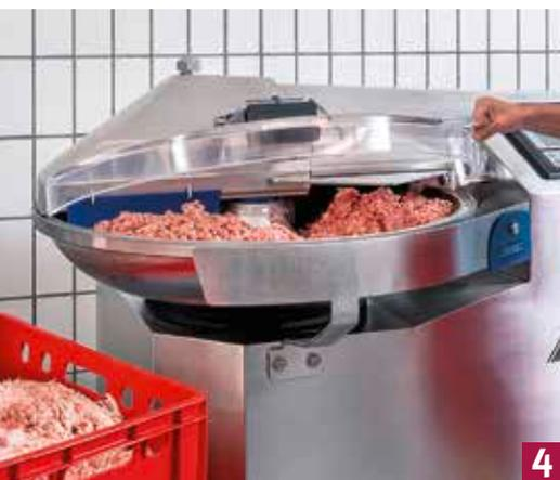
1. Dank Stauwand ist das Brät im verkleinerten Schneidraum besonders schnell gekuttert, perfekt gebunden und fertig zum Abfüllen.
