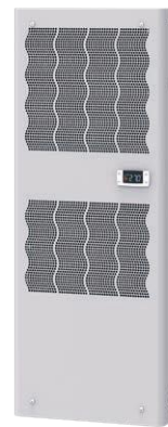
SLIM Klimatyzator mocowany w drzwiach lub osłonie bocznej z możliwością częściowego lub całkowitego wpuszczenia do wnętrza szafy. Moc chłodząca od 550 do 4000 W
