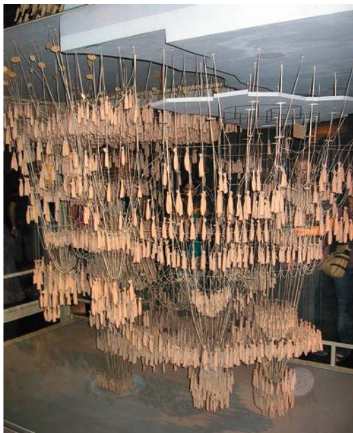
Güell koloniako eliza diseinatzeko Gaudík landu zuen maketa. Alderantziz zintzilikatu zuen, eta hamar urtez probatu zituen katenariak, egitura osatzeko. ARG.: CANAAN/CC_BY-SA.
