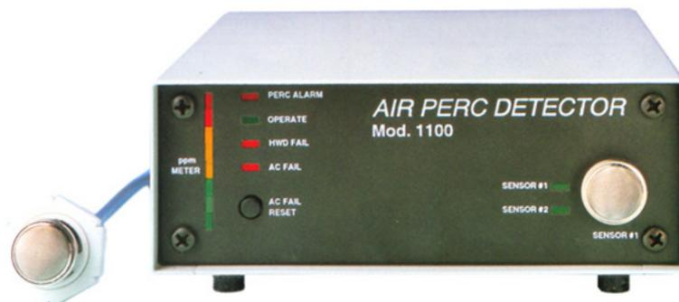
El dispositivo **Air Perc Detector Mod. 1100** tiene la función de detectar la cantidad de Percloroetileno en el ambiente en partes por millón (ppm) y proporcionar una señal de alarma cuando los niveles de los gases alcanzan un valor nocivo.
