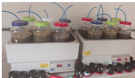
Experimento em laboratório para aumentar a produção de metano a partir de dejetos suínos e resíduos de bagaço de laranja
