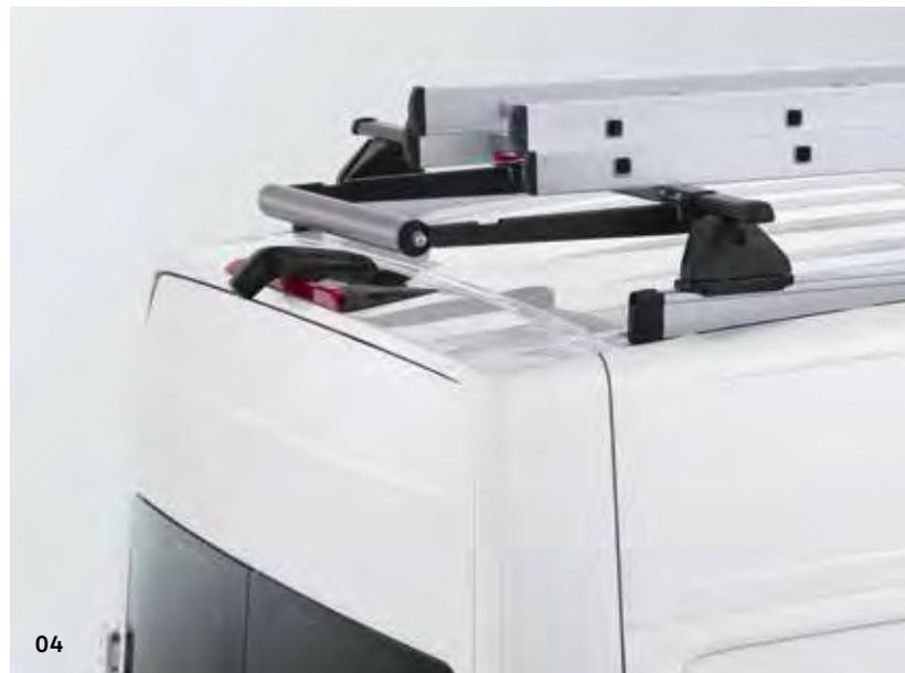
**04** Ein nützlicher Helfer ist die **Volkswagen Original Laufrolle**. Sie wird am hinteren Grundträger montiert. Gegenstände können dadurch kratzfrei einfach nach vorne geschoben werden. Die Beladung des Dachs mit grossen Transportgütern wird so zum Kinderspiel.
