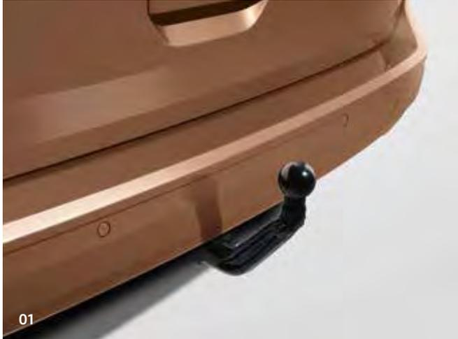
**01** Transportlösungen, die „ziehen“. Mit der nachrüstbaren starren (o. Abb.) oder abnehmbaren **Volkswagen Original Anhängervorrichtung (01)** schaffen Sie die ideale Grundlage für die Anbringung beispielweise eines Fahrradträgers oder von Anhängern<sup>1</sup> aller Art. Der erforderliche 13-polige **Elektro-Einbausatz** (o. Abb.) muss separat bestellt werden.
