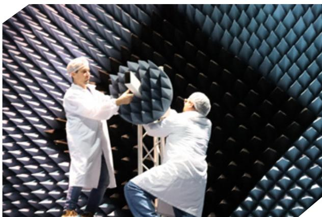
El LaMA dispone de **3 Cámaras Anecoides de diferentes tamaños**, equipadas con instrumentos de medición de alta calidad, que permiten realizar distintos tipos de ensayos según los requerimientos solicitados por los clientes. Los sistemas de coordenadas que se pueden utilizar son *Planar, Cilíndrico y Esférico*.
