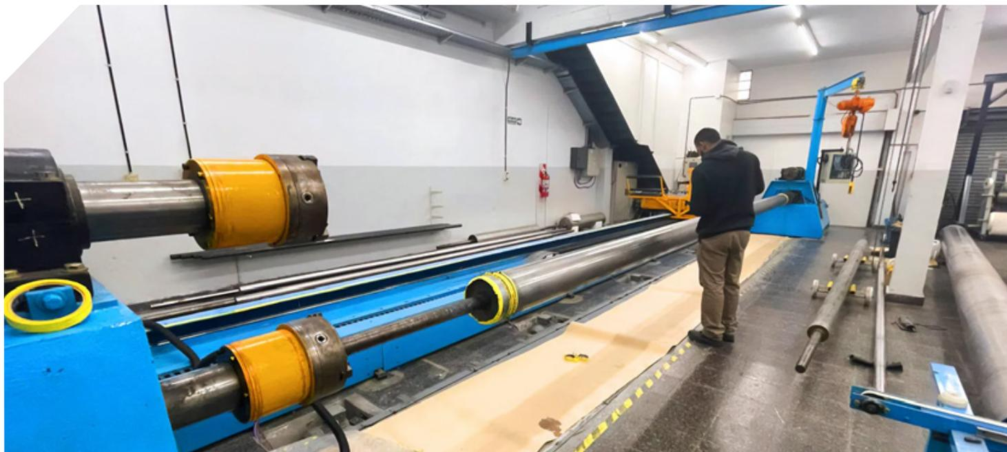
Servicios de diseño y bobinado de materiales compuestos. Tenemos la capacidad de fabricar grandes piezas, del orden de 1500 mm de diámetro y 9000 mm de largo, de óptimas prestaciones de resistencia mecánica vs peso.
