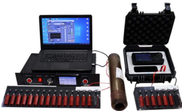
Está destinado a aplicaciones de punzado en pozos convencionales y no convencionales. Posee gran versatilidad ya que puede utilizarse en intermedios con puerto lateral de cañones a partir de 2 3/4" y de fácil utilización en modulares. El SDE VENG permite la selección individual del detonador a utilizar con capacidad para iniciar cordón detonante ETACORD 80 RDX.
