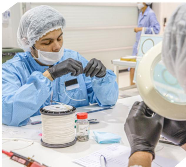
A su vez, contamos con equipamiento y procesos para realizar ensayos de tracción que garanticen la integridad de los lotes según requerimientos, y podemos ofrecer imágenes RX como complemento a los reportes de fabricación, incluyendo ensayos de aislamiento y continuidad utilizando EGSEs específicos. Todo lo llevamos a cabo en nuestras salas limpias ISO 7 o ISO 8, como así también podemos realizar ensayos de RF en nuestras cámaras anecoicas.
