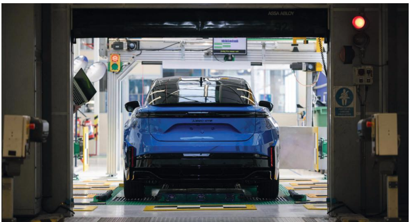
Elke auto die van de band rolt, wordt op een kleine testpiste aan een finale check onderworpen.
