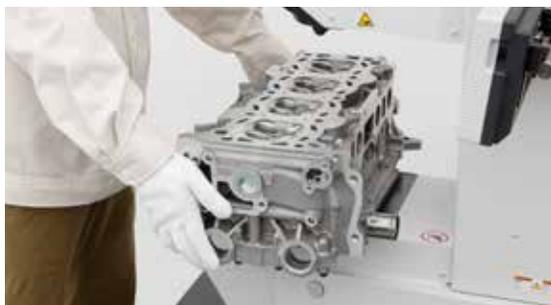
Las piezas de trabajo grandes, como los bloques de cilindros, se pueden montar sobre la platina tal cual. Se admite la prueba de piezas pesadas de hasta 100 kg.
