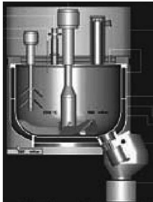
ภาพที่ 66 : Colette Hi Shear Mixer
