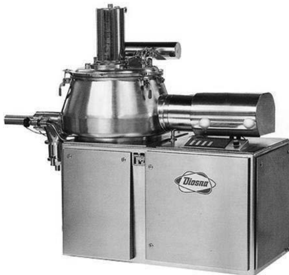
ภาพที่ 67 : Diosna Hi Shear Mixer
