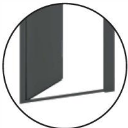
Interposition OSB entre les tôles d'acier
