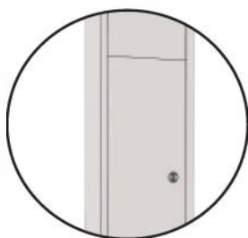
Fermeture de la trappe par serrures
