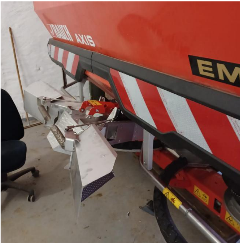
Abbildung 1: Für punktgenaues Grenzstreuen eignet sich ein Mittenschirm als Anbauelement für einen Schleuderstreuer.
