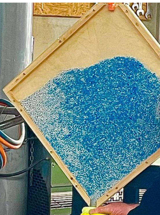
Abbildung 3: Entmischung der Düngerkörner aufgrund unterschiedlicher Korngrößen; farblich markiert
