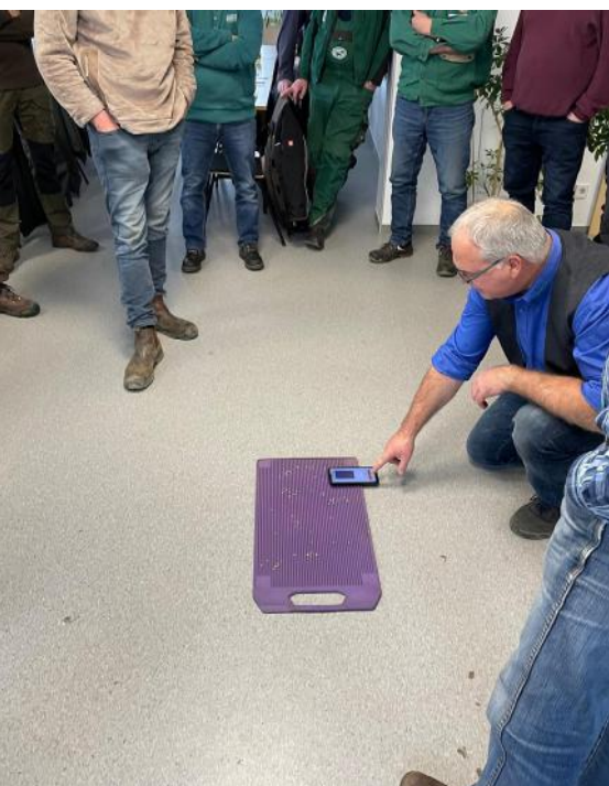
Abbildung 2: Auswertung der Querverteilung mit Hilfe von Streumatten mittels App und KI. Die Prüfung der Plausibilität ist unbedingt zu beachten.
