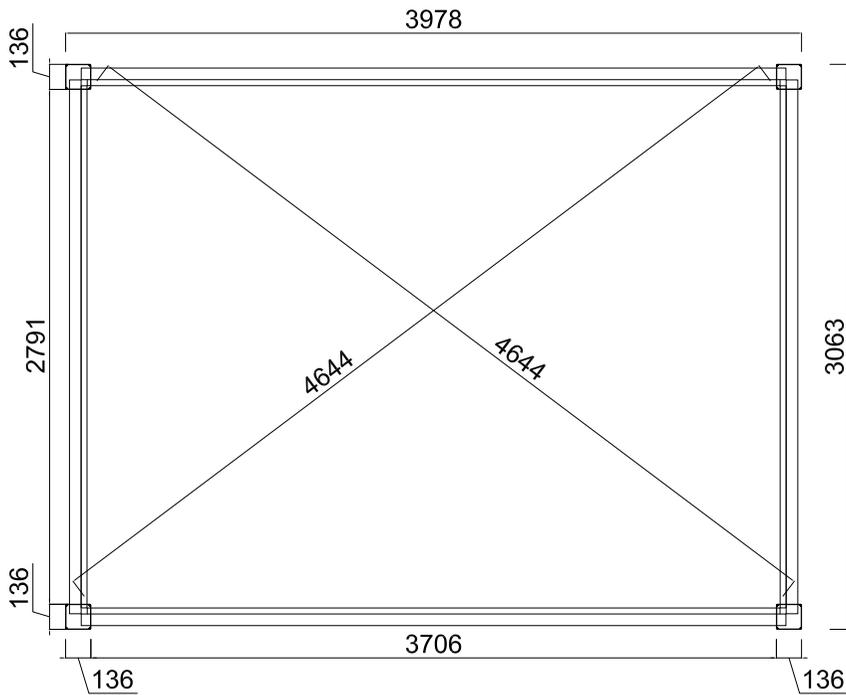
Grundrissplan der Bodenplatte
