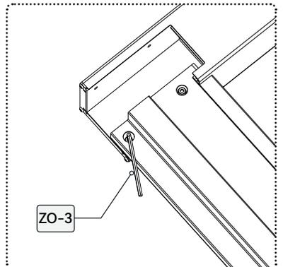
Zuerst die Sekundärträger positionieren, gefolgt von den Primärträgern, wobei das Motorkabel am Primärträger zu beachten ist. Anschließend das Motorkabel vom Steuergerät mit dem Motor verbinden.
