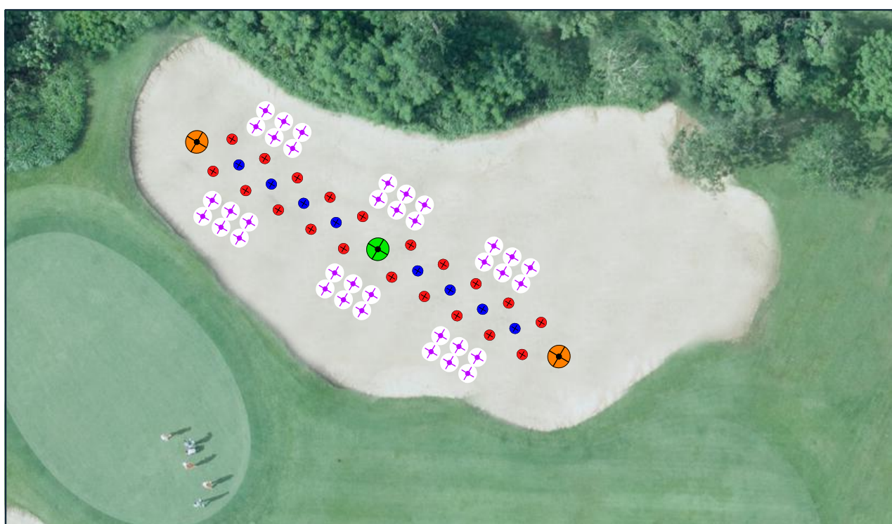
Figure 16 – Un bunker d'entraînement de golf avec EXLTERRA BSTR hors ligne. Les unités BSTR sont de chaque côté de la ligne de GEPS parce que le flux d'eau arrive dans la ligne d'EXLTERRA GEPS depuis deux directions.
