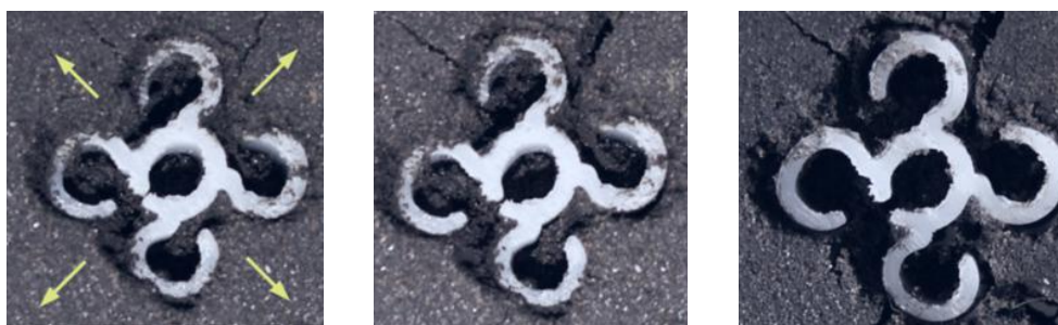
Figure 5 – Lames de l'unité EXLTERRA GEPS s'ouvrant lorsque le sol est sec.
