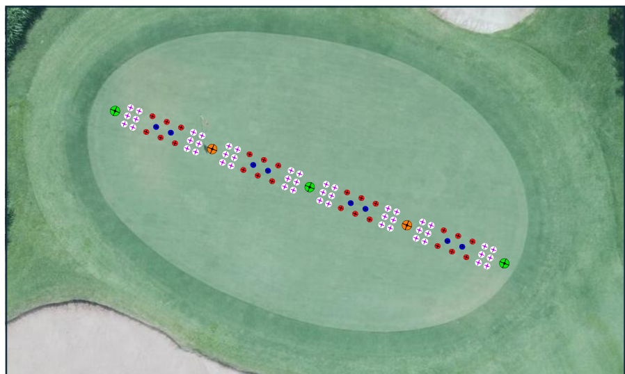
Figure 15 – Un green concave sur un terrain de golf utilisant le schéma diamant avec une ligne de EXLTERRA BSTR.
