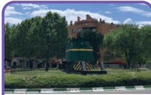
10.- Glorieta del Tren. Locomotora diésel construida en 1965 en Barcelona. Se trata de una locomotora para servicio de maniobras, con una potencia de 350 CV y tres ejes, dos de ellos motores. Desarrolla una velocidad máxima de 45 Km/h.
