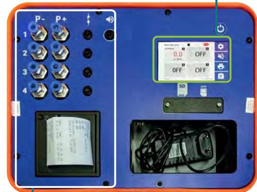
Unter- & Überdruckanschlüsse, Relais-
