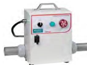
Der PC 20 HP wird zwischen Schleifmaschine und Gefahrstoffsauger geschaltet. Er erkennt unverzüglich einen Unterdruckabfall und unterbricht sofort die Stromzufuhr der Schleifmaschine. So verhindern Sie zuverlässig die ungehinderte Verbreitung gefährlicher Schleifpartikel.
