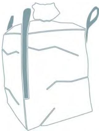
Ein Big Bag ist ein flexibler Schüttgutbehälter (intern. Kurzbezeichnung: FIBC - Flexible Intermediate Bulk Container). Das Gewebe besteht zumeist aus Polypropylen.
