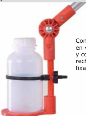
Convient pour tous flacons en plastique et en verre d'un diamètre maximum de 88 mm, y compris les flacons de 750 ml (flacon de rechange réf. 9.072 987). Avec collier de fixation rapide universel.
