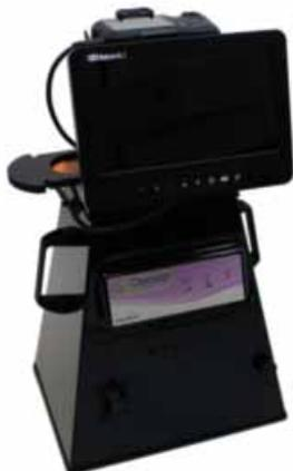
Transfert de données vers l'ordinateur possible avec le logiciel TotalLab™ 1D en option. Utilisation en combinaison avec tout transilluminateur UV 21 x 21 cm. Enregistrement des données sur la carte mémoire possible en RAW, TIFF-RGB et JPEG.
