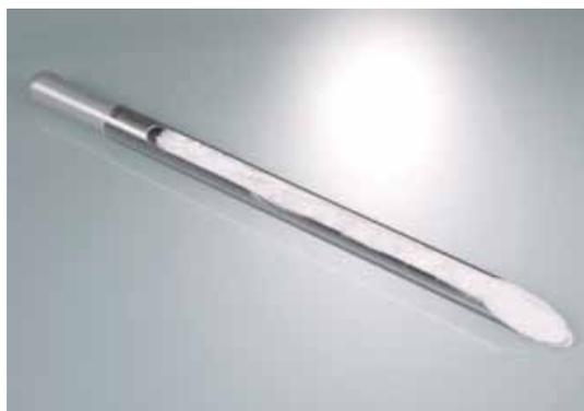
Préleveur d'échantillon pour tout type de poudre et granulés en acier inox VA4. Développé à l'origine spécialement pour les échantillons de lait en poudre, conforme aux normes DIN et IDF (Int. Dairy Federation). Le préleveur est inséré dans des sacs ou des fûts et l'échantillon est retiré à l'aide d'une lance à profil semi-circulaire. Autoclavable.
