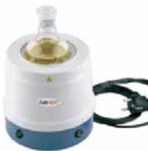
Chauffe-ballon LabHEAT® pour ballons à fond rond. Élément de chauffe en soie de verre flexible dans un boîtier métallique revêtu de plastique, chimiquement résistant avec commutateur et interrupteur pour zone de chauffe intégrés. La température maximale de l'élément chauffant est de 450 °C. Câble d'alimentation de 1,5 m avec prise de terre et interrupteur différentiel, tension nominale 230 V.
