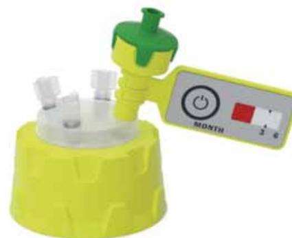
Bouchons à vis, avec un insert tournant librement en PP, avec filetage interne UNF 1/4" 28G, pour le raccord de capillaires (dia. ext. 3,2 mm) et une soupape d'aération. Sans polyoléfine halogène. 3 raccords de capillaires.
