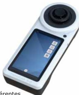
Le photomètre avec 18 longueurs d'onde différentes (3 capteurs avec 6 longueurs d'onde chacun) couvre l'ensemble du spectre visible, ainsi que des parties importantes du spectre UV et IR.
