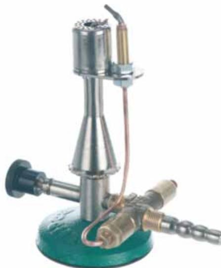
Température max. 1300°C, robinet à pointeau. Matériau Ms-Ni. **Élément de sécurité thermique** (détecteur de flamme bimétallique avec fermeture magnétique). Régulateur d'air et veilleuse. Un revêtement caoutchouc anti-dérapant en dessous de la base assure une stabilité absolue.
