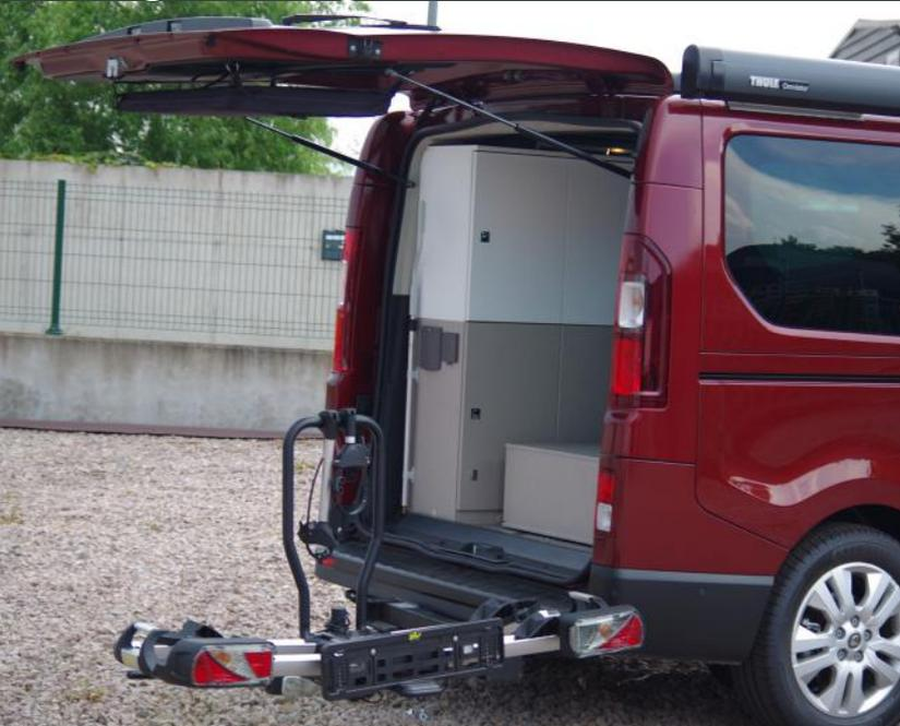
Le système SWING FLEX est composé d'un attelage, d'un bras pivotant, d'une boule et d'un porte-vélos amovible.
