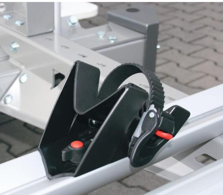
Nos nouveaux bras de maintien sont dotés d'une fermeture à cliquet pour une fixation optimale et d'un habillage rembourré et doux pour éviter d'abimer vos vélos.
