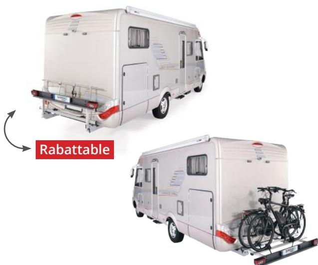
Repliable, le porte-vélos **E-Bike** permet de charger jusqu'à 2 vélos électriques ou 3 vélos standards.
