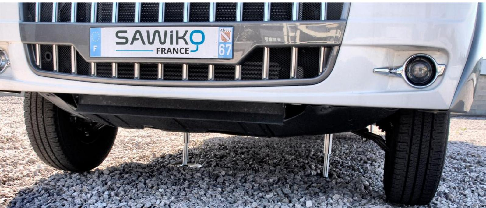
Notre système de vérins hydrauliques vous permet de niveler rapidement votre véhicule. Grâce à un écran tactile, vous pourrez suivre les différentes étapes de la mise à niveau.
