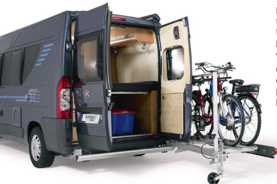
Le porte-vélos AGITO TOP présente une fonction sur pivot et roue jockey. Une fois posé au sol, le porte-vélos peut alors pivoter et permettre l'accès aux portes arrières du véhicule.
