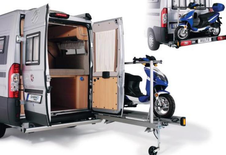
Le système **AGITO** a été développé pour une large gamme de fourgons. Grâce à un système de pivot sur la roue jockey, il est facile de déplacer la charge tout en dégagant totalement l'accès aux portes arrières du fourgon. Démontable sans outils.
