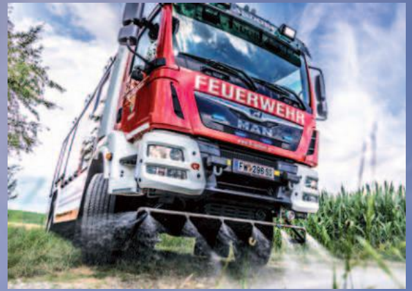
Fix verbaute Straßenwaschanlage
