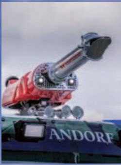
Aus dem Fahrerhaus steuerbarer Wasserwerfer
