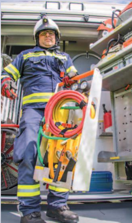
Einfache Entnahme von Geräten. Hier: Steuergerät für Hebekissen
