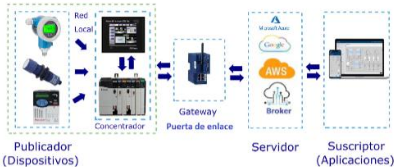
Figura 3. Elementos de un sistema IIoT.
