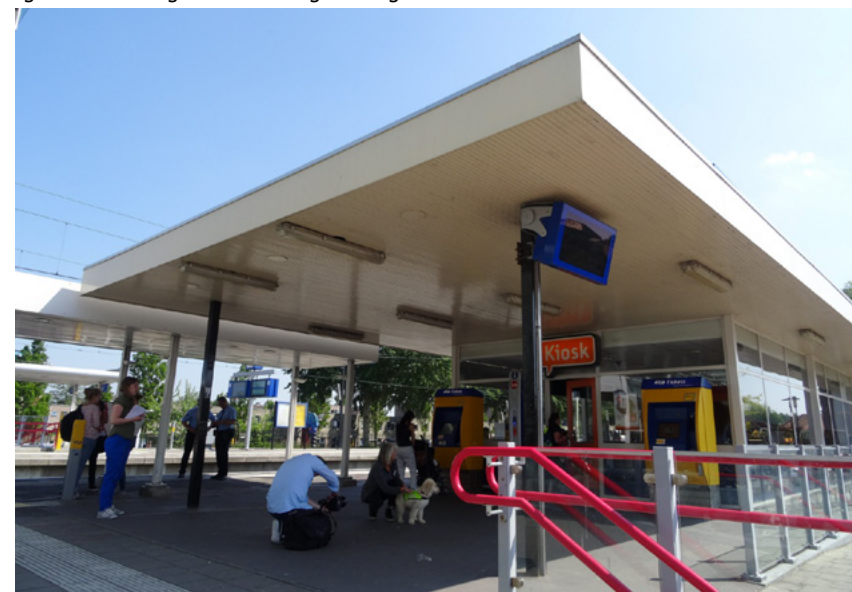
Afb. 5.25 De zwartgeverfde stalen staanders onder de overdekte voorruimte en de witgeverfde stalen staanders in de glaswanden.
