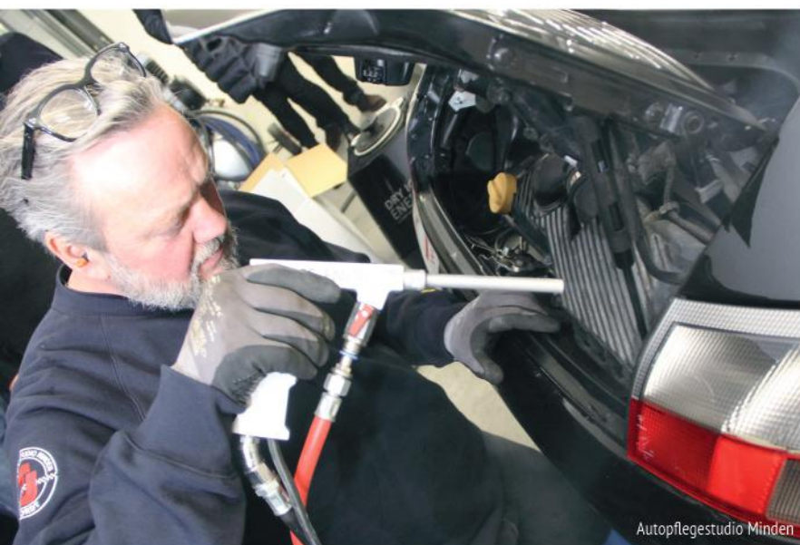
Bei der Motorwäsche mit Trockeneis – hier im Autopflegestudio Minden – entsteht kein Wasser und keine Feuchtigkeit. Dadurch wird kein Bauteil durch festes Strahlgut beschädigt und ist zudem umweltschonend.
