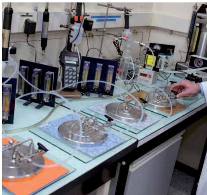
Célula de emisiones de COV (equipo del centro de I+D de Gerflor)
