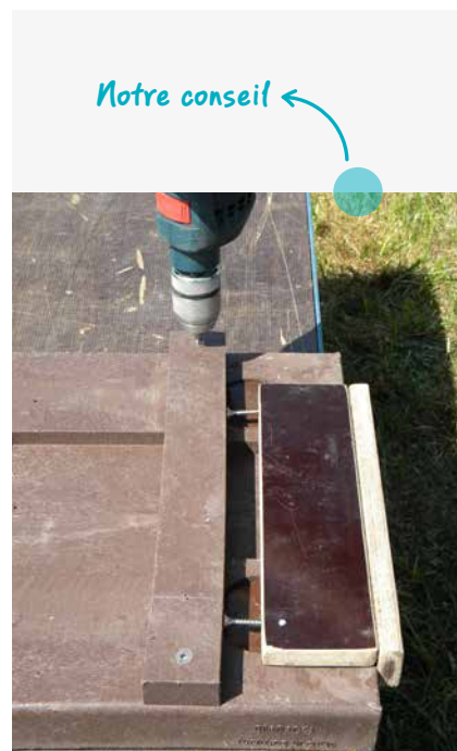
Utilisation de socle préposé pour un angle à 90°
