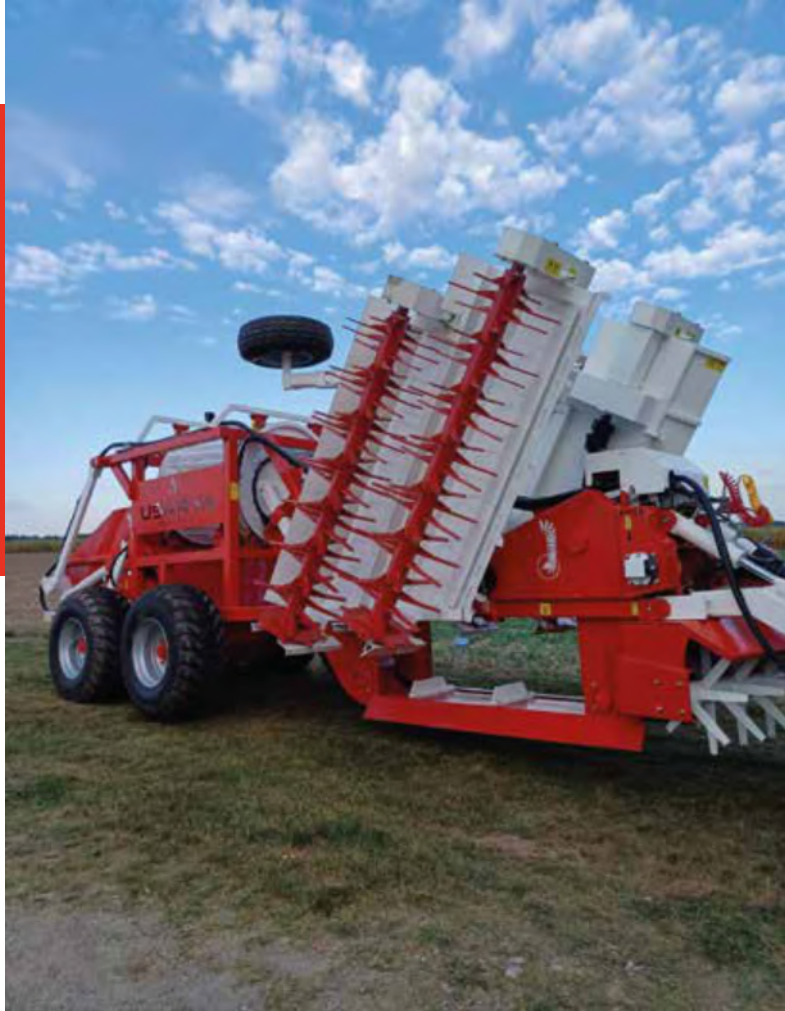
HUSARYA SCS-100 Et patenteret system med dobbelte rotor, der muliggør opsamling af sten i et bredt størrelsesinterval.
