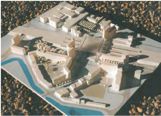
Inzending AMRO i.s.m. Kuiper Compagnons (Rotterdam) en DHV (Amersfoort): vlnr maquette, vogelvluchtperspectief en voorgevelaanzicht. Belangrijk ingrediënt is een brede spoortunnel waarin zowel trein- als busstation worden ondergebracht. Hoge kantooortorens markeren de verbinding tussen de twee stadsdelen aan weerszijden van het spoor
