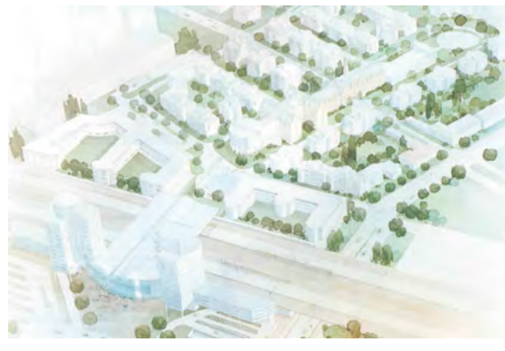
Winnende inzending van MABON i.s.m. Hoogstad Van Tilburg architecten (Rotterdam) en Articon (Amersfoort): vlnr maquette, vogelvluchtperspectief en voorgevelaanzicht. Belangrijkste ingrediënten: tweezijdig station, gelijkvloers voetgangersdomein via passage, afz. fiets- en bustunnel, twee kantooortorens aan de stadszijde en autotunnel voorlangs het station (bron: alle afbeeldingen op deze pagina zijn afkomstig uit Stadswerk (1989), nr. 25, maart).
