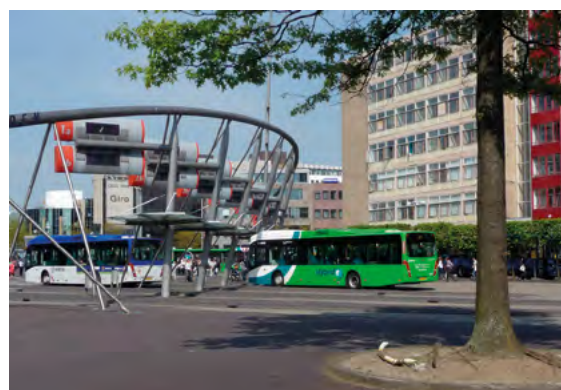
Bus: op het busstation geven digitale schermen aan waar een bus vertrekt. De schermen zijn opgehangen aan een 70 meter lange gekromde buis: als ware het een waslijn. Bureau N | P | K industrial design leverde hiervoor het ontwerp.
