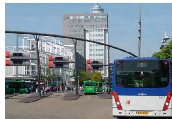
Bus: op het busstation geven digitale schermen aan waar een bus vertrekt. De schermen zijn opgehangen aan een 70 meter lange gekromde buis: als ware het een waslijn. Bureau N | P | K industrial design leverde hiervoor het ontwerp.
