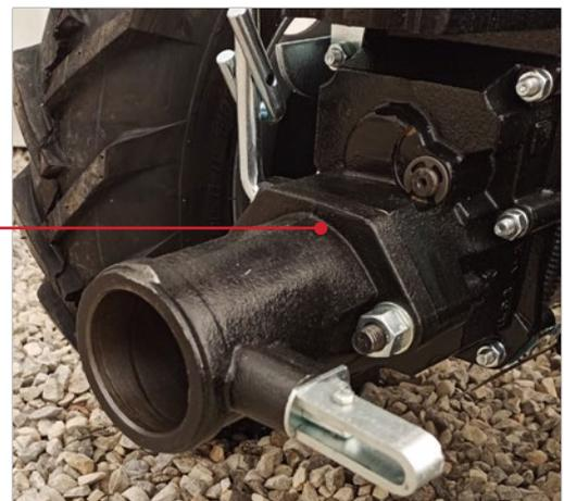
Bei allen S-trak Schleppertypen serienmäßige Schnellkupplung zum werkzeuglosen Anbaugerätewechsel.
