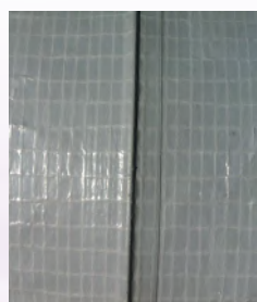
Tissu polyester enduit de résines polyoléfines
