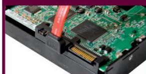
COUDÉ VERS LE BAS! POUR DISQUE DUR INSTALLÉ EN HAUT
