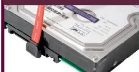
COUDÉ VERS LE HAUT! POUR DISQUE DUR INSTALLÉ EN BAS
