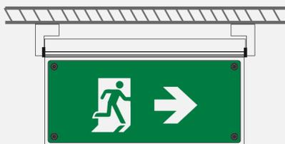
Montagem embutida no teto suspenso com base de montagem.
