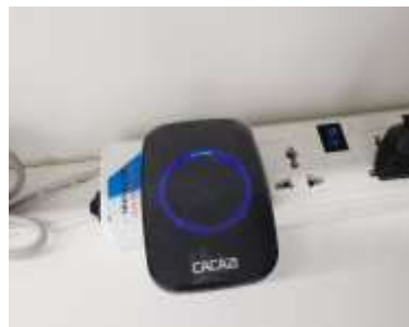
ภาพที่ 3 จุดติดตั้งตัวรับสัญญาณไฟและเสียง
