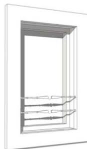
Les fenêtres extérieures doivent être réservées à l'éclairage des pièces habitables avec des ouvrants à la française. Elles doivent être plus hautes que larges avec une surface supérieure à 1,50m<sup>2</sup>. Les ouvrants et les linteaux peuvent être droits ou sous formes d'arcs à l'exemple des exemples proposés.
