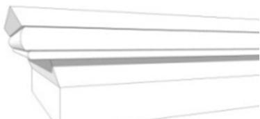
La frise doit être exécutée dans le respect des épaisseurs, des proportions et des détails. Les différents motifs et encadrement doivent faire partie intégrante de la masse du mur.
