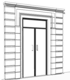
Les portes au rez de chaussée sont en verrière qui affère la transparence recherchée, les percements au niveau de la façade reçoivent des encadrements qui les mettent en relief et rehaussent la composition.
