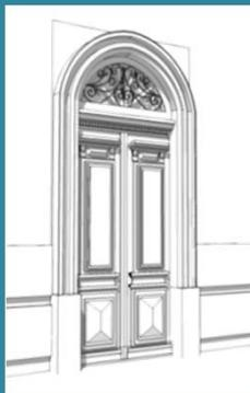
Les portes utilisées sont encadrées dans un soubassement en faisant partie intégrante du mur et reçoivent un arc surbaissé.
