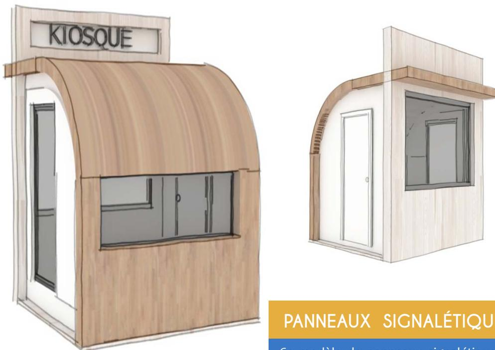
Ce modèle de kiosque est constitué d'un plan vertical en bois avec une toiture en pente. Il dispose d'un garde-corps et des ouvertures de taille et de typologie différentes. Le design du kiosque s'adapte avec le contexte de la ville contemporaine avec ses matériaux légers et contemporains et son rapport plein/vide assez réduit.
