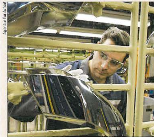
Werkstücke auf Oberflächenfehler prüfen
