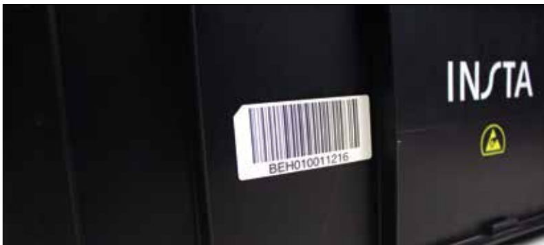
Een niet verwijderbare barcode op een bak d.m.v. in-mould labeling.
