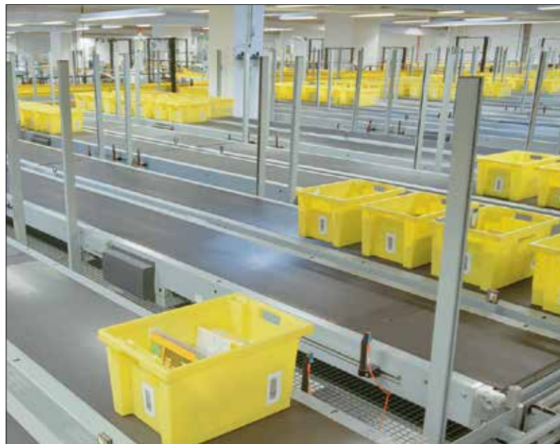
Bakken met versterkte bodem op een distributiesysteem voor e-fulfilment. (Foto: Vanderlande Industries)
