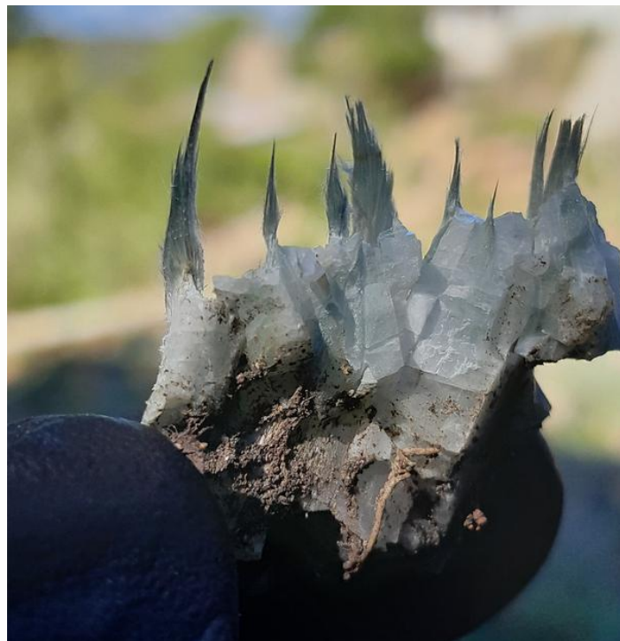
De l'actinolite, amiante retrouvée lors de l'analyse d'un mur de soutènement à Focicchia en Haute-Corse - ©Bureau GDA
