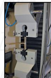
Peeling Lamination strength (EN 12774)
