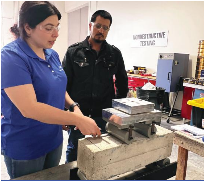
Victoria Lopez muestra a un candidato en los procedimientos correctos para el ensayo de resistencia a la flexión en una sesión práctica.
