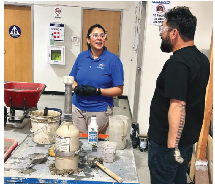
Andrea Godoy trabaja con un candidato en una sesión práctica de contenido de aire por el método volumétrico.
